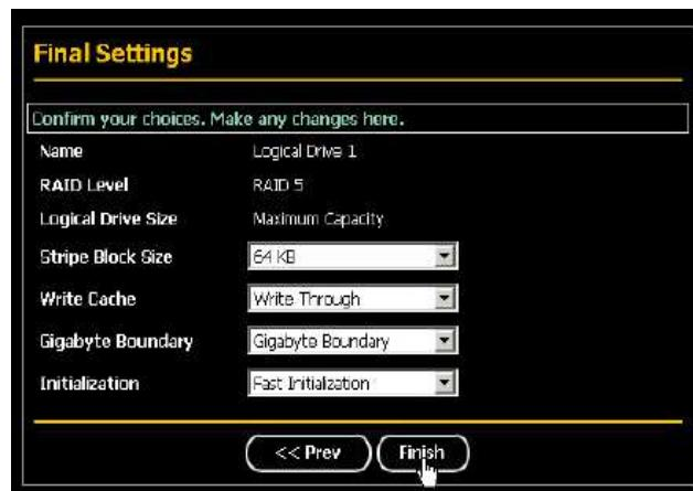
14. 按一下**完成**按鈕。若有實體磁碟機可用，將會再次出現選取RAID層級畫面，您可在此建立其他邏輯磁碟機。按一下樹狀檢視中的**邏輯磁碟機**，查看新邏輯磁碟機的所有資訊。
