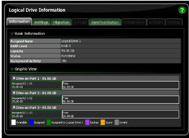
在可使用新的邏輯磁碟機之前，您必須使用 PC 的作業系統分割與格式化邏輯磁碟機。
