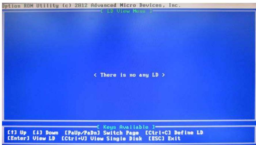
選擇您要的 RAID 層級。在定義 LD 功能表區段中，按下空格鍵可循環顯示邏輯磁碟機類型，包括 RAID 0、RAID 1、RAID 5 及 RAID 10。
