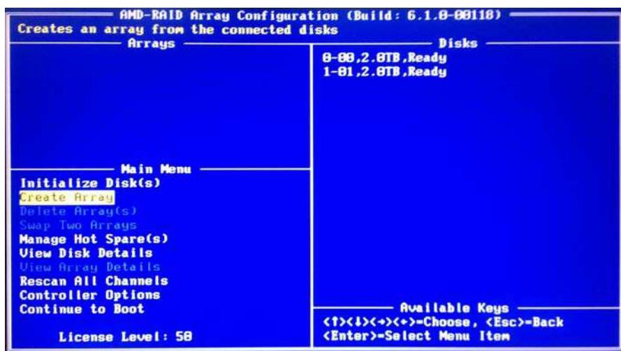
使用上下鍵選擇磁碟，再按 <Insert> 鍵將確認選取，被選取的硬碟字體會變為綠色，若欲使用所有硬碟做為磁碟陣列，按下<A>即可。選取完成後請按 <Enter> 鍵確認。
