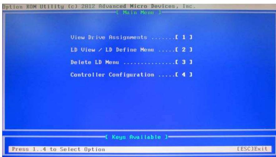
按下主功能表畫面上的 2，顯示「定義 LD 功能表」。按下 <Ctrl+C> 鍵建立磁碟陣列。
